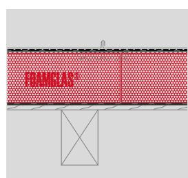
**Kompaktdach mit Falzblech- / Profilblecheindeckung auf Holzschalung**
