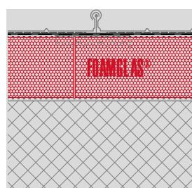
**Kompaktdach mit Falzblech- / Profilblecheindeckung auf Stahlbeton**
