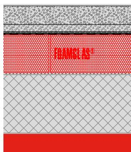
**Kompaktdach befahrbar mit Vermörtelungsbelag**
