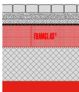
**Kompaktdach befahrbar mit Pflastersteinbelag**
