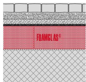
**Kompaktdach befahrbar mit Pflastersteinbelag**
