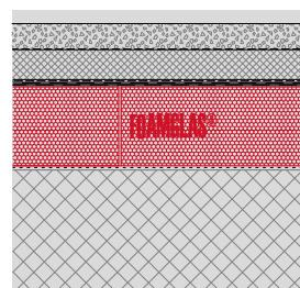
**Kompaktdach befahrbar mit Asphaltbelag**
