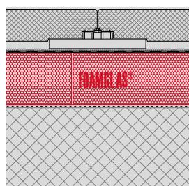
**Kompaktdach befahrbar mit Betonplatten auf Stelzlager**
