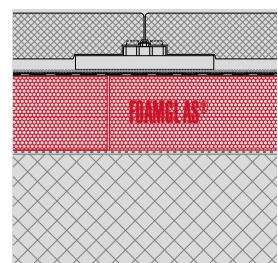
**Kompaktdach befahrbar mit Betonplatten auf Stelzlager**
