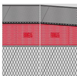
**Kompaktdach befahrbar mit Ortbetonplatte**
