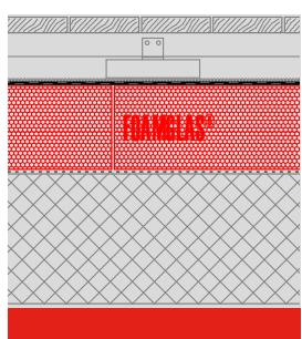
**Kompaktdach mit Holzrost auf Stahlbeton**
