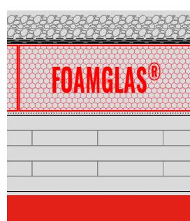
**Toiture compacte inaccessible et technique sur support bois massif CLT sous gravillons**
