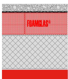
**Kompaktdach bekiest auf Stahlbeton**
