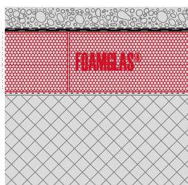
**Kompaktdach bekiest auf Stahlbeton**
