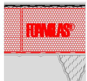
**Kompaktdach ohne Nutz- und Schutzschicht auf Akustik-Trapezblech**
