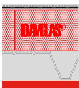
**Kompaktdach ohne Nutz- und Schutzschicht auf Trapezblech**
