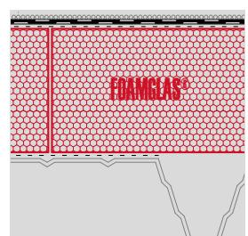
**Kompaktdach ohne Nutz- und Schutzschicht auf Trapezblech**
