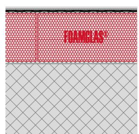
**Kompaktdach ohne Nutz- und Schutzschicht auf Stahlbeton**
