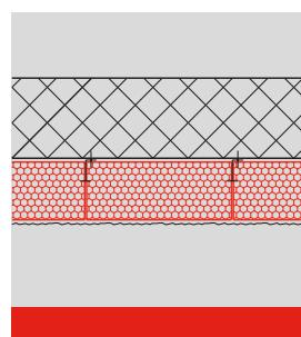
**Deckendämmung mit armerter Grundbeschichtung**
