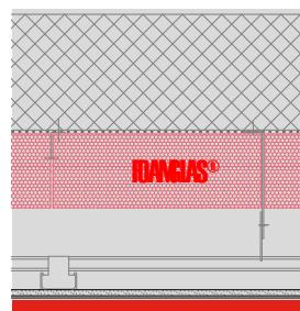
**Isolation pour plafond avec recouvrement en panneaux et tiges taraudées**
