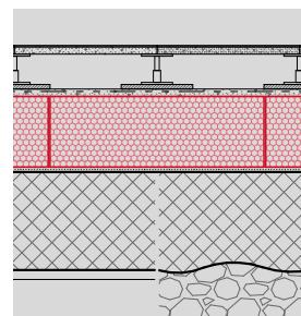
**Isolamento di pavimenti tecnici sopraelevati**
