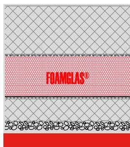
**Isolation de sol (résistante aux charges) sur béton de support avec étanchéité**
