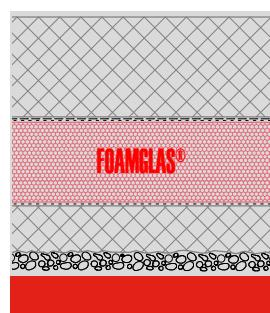
**Bodendämmung (lastabtragend) auf Unterlagsbeton mit WU-Beton****(«Weisse Wanne»)**
