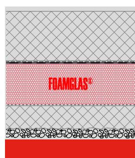
**Bodendämmung (lastabtragend) mit Abdichtung auf Unterlagsbeton**
