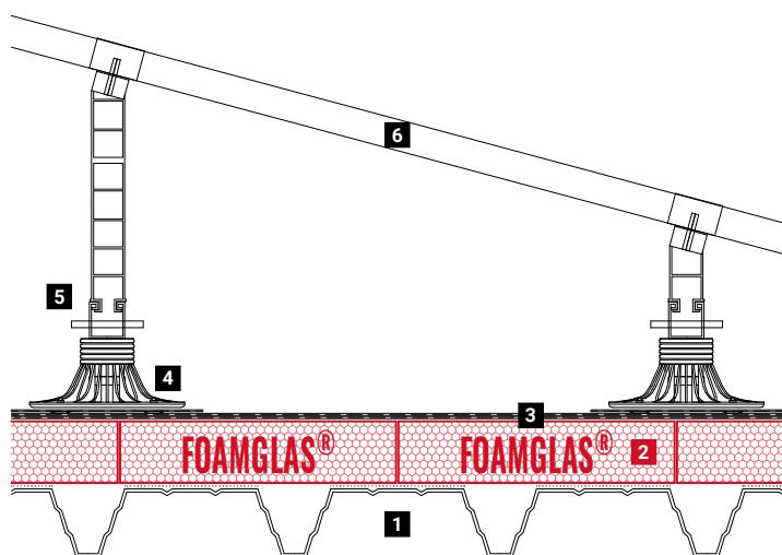
1. Tôle d'acier nervurée
