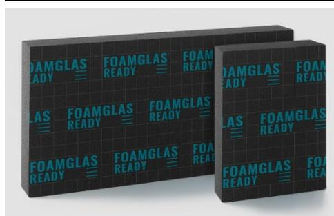
FOAMGLAS® READY T3+ è costituito da una lastra di FOAMGLAS® T3+. La superficie superiore è rivestita con uno strato di bitume, protetto da un film termo fusibile, che consente di saldare a fiamma membrane bituminose; è identificata dal colore azzurro. La superficie inferiore è nuda.
