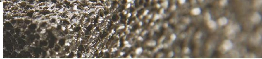
FOAMGLAS® WALL BOARD ALU T3+ est composé de plaques FOAMGLAS® T3+ assemblées à l'aide de bitume. La face supérieure du panneau est revêtue d'une feuille d'aluminium (4 µm, de couleur noire avec impression jaune), et la face inférieure d'un voile de verre minéral blanc.
