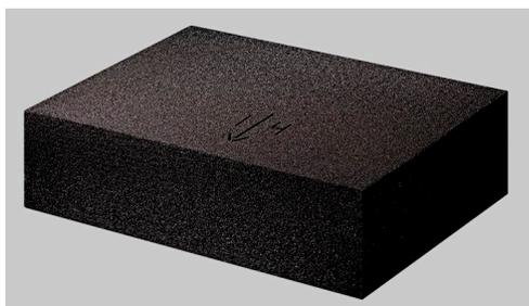
FOAMGLAS® TAPERED T4+ è costituito da una lastra di FOAMGLAS® T4+ rastremata in tutta la sua larghezza, o talvolta la sua lunghezza. Una freccia centrale e un numero incisi sulla superficie superiore indicano la direzione di deflusso delle acque meteoriche e la corretta collocazione della lastra in relazione a un disegno di posa fornito con la consegna del prodotto.
