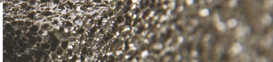
FOAMGLAS® READY TAPERED T4+ besteht aus FOAMGLAS® T4+ Platten, die bei der Herstellung mit Gefälle zugeschnitten und mit einer PE-Flämmfolie versehen sind, die ein direktes Aufschweißen einer Bitumenschweissbahn ermöglicht. Ein Pfeil, der auf die vertikale Oberfläche der niedrigsten Seite gestempelt ist, zeigt die Fallrichtung an.
