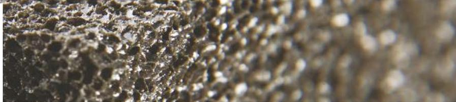
FOAMGLAS® READY T4+ est une plaque FOAMGLAS® T4+ revêtue, sur la face supérieure, d'une couche de bitume et d'un film thermofusible sur lequel les membranes d'étanchéité peuvent être soudées directement à la flamme.
