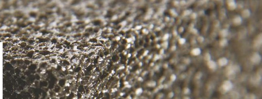
FOAMGLAS® READY T3+ est une plaque FOAMGLAS® T3+ revêtue, sur la face supérieure, d'une couche de bitume et d'un film thermofusible sur lequel les membranes d'étanchéité peuvent être soudées directement à la flamme.
