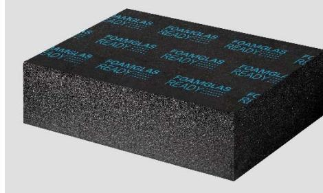
FOAMGLAS® READY S3 est un panneau de format 600 x 450 mm composé de verre cellulaire FOAMGLAS® S3. La face supérieure du panneau est pourvue d'un revêtement spécial bitumé, qui permet de poser des lés d'étanchéité par soudure.
