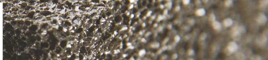
FOAMGLAS® READY BOARD T4+ est composé de plaques FOAMGLAS® T4+ assemblées à l'aide de bitume. La face supérieure du panneau est revêtue d'une couche de bitume et d'un film thermofusible sur lequel les membranes d'étanchéité peuvent être soudées directement à la flamme, et la face inférieure d'un voile de verre minéral blanc.
