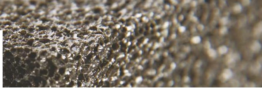
Le panneau FOAMGLAS® READY BOARD T4+ se compose de plaques FOAMGLAS® T4+ collées ensemble. La face supérieure est revêtue d'une couche de bitume et doublée d'une feuille de PE pour permettre la mise en œuvre directe de membranes bitumineuse par soudage. La face inférieure est doublée d'un non-tissé de verre blanc.
