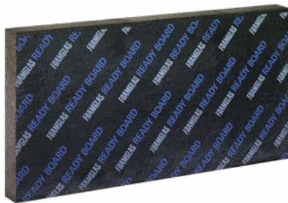
FOAMGLAS® READY BOARD T4+ è composto da lastre FOAMGLAS® T4+ incollate insieme e rivestite con uno strato di bitume foderato con un foglio di PE che consente l'applicazione diretta di membrane impermeabilizzanti a fiamma. Il lato inferiore della lastra è rivestito con un velo di vetro bianco.
