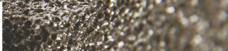
Le panneau FOAMGLAS® READY BOARD T4+ se compose de plaques FOAMGLAS® T4+ collées ensemble. La face supérieure est revêtue d'une couche de bitume et doublée d'une feuille de PE pour permettre la mise en œuvre directe de membranes bitumineuse par soudage. La face inférieure est doublée d'un non-tissé de verre blanc.
