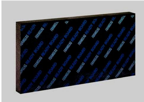
FOAMGLAS® READY BOARD T4+ bestehen aus verklebten FOAMGLAS® T4+ Platten. Oberseitig ist eine Bitumenkaschierung und unterseitig ein weisses Spezialglasvlies aufgebracht. Die Oberseite ist zum Aufschweissen von Bitumenbahnen geeignet.
