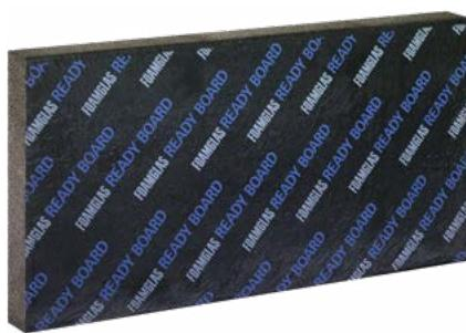
FOAMGLAS® READY BOARD T3+ est composé de plaques FOAMGLAS® T3+ assemblées à l'aide de bitume. La face supérieure du panneau est revêtue d'une couche de bitume et d'un film thermofusible sur lequel les membranes d'étanchéité peuvent être soudées directement à la flamme, et la face inférieure d'un voile de verre minéral blanc.
