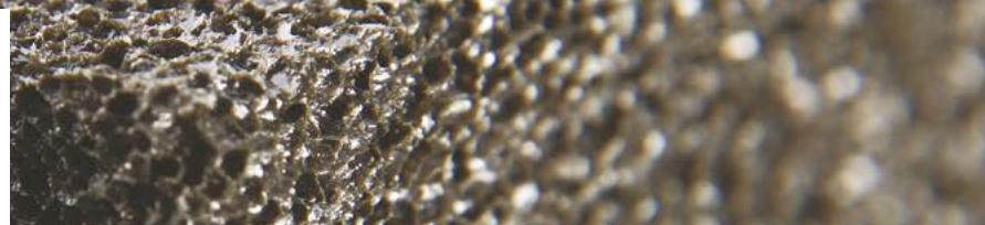
El FOAMGLAS® READY BOARD T3+ está compuesto por placas FOAMGLAS® T3+ unidas entre sí con betún y forradas con una lámina de PE que permite la aplicación directa de membranas impermeabilizantes con soplete. El lado inferior de la placa está forrado con un vidrio blanco.
