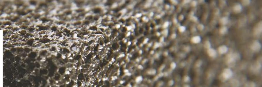
FOAMGLAS® READY BOARD T3+ besteht aus FOAMGLAS® T3+ Platten, die mit Bitumen verklebt und mit einer PE-Flämmfolie versehen sind, die ein direktes Aufschweißen einer Bitumenschweißbahn ermöglicht. Die Unterseite der Platte ist mit einem weißen Glasvlies versehen.
