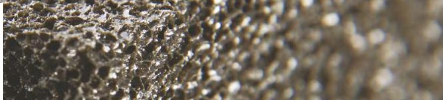
FOAMGLAS® PERINSUL HL ist ein hochdichtes Dämmprodukt, das speziell entwickelt wurde, um geometrische Wärmebrücken im Fußpunkt von Wänden zu eliminieren. Die Ober- und Unterseiten des Dämmblocks sind mit Bitumen und mit einem grün bedruckten PE/Glasvlies-Verbundmaterial versehen, das mit Mörtel verträglich ist. FOAMGLAS® PERINSUL HL muss in einem einzigen Arbeitsvorgang installiert werden.
