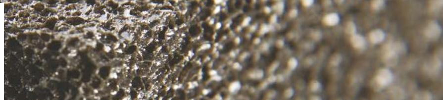
Le block FOAMGLAS® PERINSUL HL est un produit d'isolation à très haute densité spécialement conçu pour traiter les ponts thermiques structurels. Les faces supérieure et inférieure du bloc isolant sont enduites de bitume et recouvertes d'un revêtement composite en PE/verre imprimé vert, compatible avec le mortier de maçonnerie. FOAMGLAS® PERINSUL HL doit être mis en oeuvre en une seule couche linéaire.
