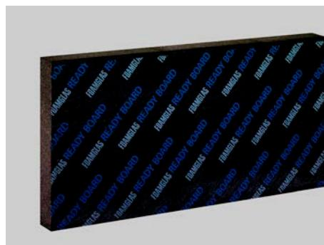
FOAMGLAS® READY BOARD T4+ est un panneau de format 1200 x 600 mm composé de plaques de verre cellulaire FOAMGLAS® T4+ assemblés entre elles. La face supérieure du panneau est pourvue d'un revêtement spécial bitumé, qui permet de poser des lés d'étanchéité par soudure. Sur la face inférieure se trouve un non-tissé blanc.
