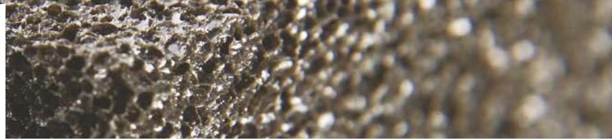
La plaque FOAMGLAS® T3+ est un matériau isolant thermique en verre cellulaire de haute performance et pérenne pour toute l'enveloppe du bâtiment. Il s'agit d'un isolant léger, rigide et durable, composé de millions de cellules de verre hermétiquement scellées. La plaque FOAMGLAS® T3+ offre la meilleure valeur lambda de notre catalogue.
