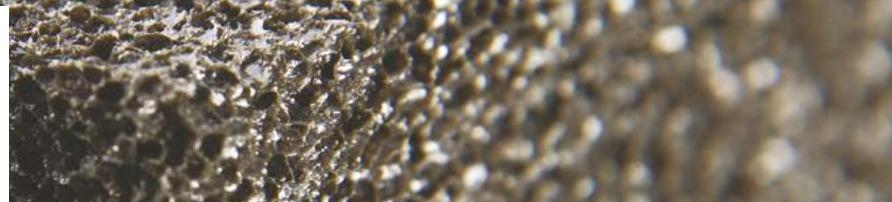
La plaque FOAMGLAS® S3 est un matériau isolant thermique en verre cellulaire de haute performance et pérenne pour toute l'enveloppe du bâtiment. Il s'agit d'un isolant léger, rigide et durable, composé de millions de cellules de verre hermétiquement scellées.
