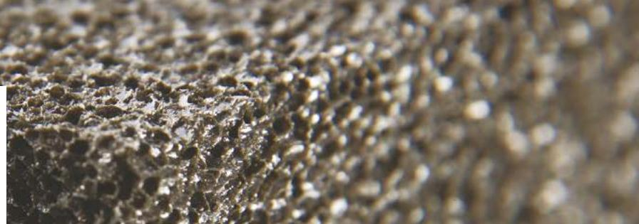
FOAMGLAS® BOARD T4+ è composto da lastre FOAMGLAS® T4+ incollate insieme e ricoperte con un rivestimento. Il lato superiore della lastra isolante è rivestito con un composito di PE-vetro (nero con stampa verde) e il lato inferiore è rivestito con un velo di vetro bianco.
