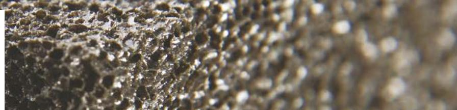
FOAMGLAS® BOARD T3+ est composé de plaques FOAMGLAS® T3+ assemblées à l'aide de bitume. La face supérieure du panneau est revêtue d'un composite voile de verre-PE (noir avec une impression jaune), et la face inférieure d'un voile de verre minéral blanc.
