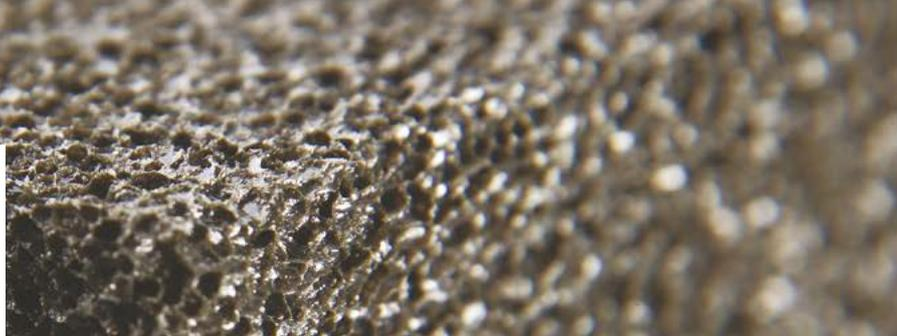
FOAMGLAS® BOARD T3+ è composto da lastre FOAMGLAS® T3+ incollate insieme e ricoperte con un rivestimento. Il lato superiore della lastra isolante è rivestito con un composito di PE-vetro (nero con stampa gialla) e il lato inferiore è rivestito con un velo di vetro bianco.
