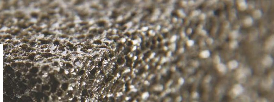
Le panneau FOAMGLAS® BOARD T3+ se compose de plaques FOAMGLAS® T3+ collées ensemble. La face supérieure de la plaque doublée composite PE (noir avec une impression jaune) et la face inférieure est doublée d'un non-tissé de verre blanc.
