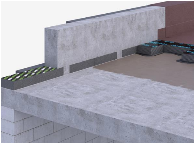
Figures 4 – exemple d'acrotère bas avec rupteur de pont thermique
