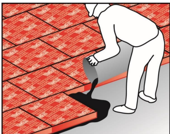
Figure 2a – verser la colle sur le support
