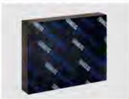
FOAMGLAS® READY BLOCK T4+ est un panneau de format 600 x 450 mm composé de verre cellulaire FOAMGLAS® T4+. La face supérieure du panneau est pourvue d'un revêtement spécial bitumé, qui permet de poser des lés d'étanchéité par soudure.
